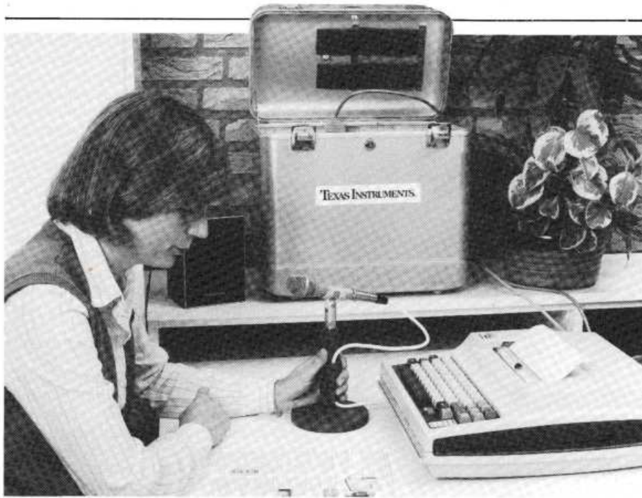
Met de PASS-koffer, een microfoon en een eenvoudige terminal kan spraak direct in EPROM worden gezet.
