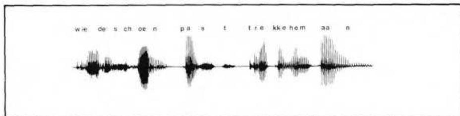
Fig. 2. Registratie van de geluidsgolf van de gesproken zin: „Wie de schoen past, trekke hem aan”. Het diagram geeft de uitgangsspanning van de microfoon (verticaal) als functie van de tijd (horizontaal).
